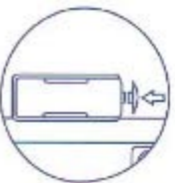
Klemmer trykkes fast mot batteripolene
